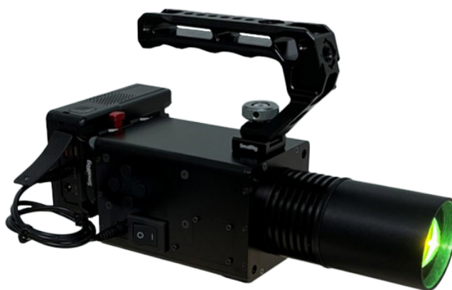
微粒子可視化用 LED 光源「パラレルアイ M」
