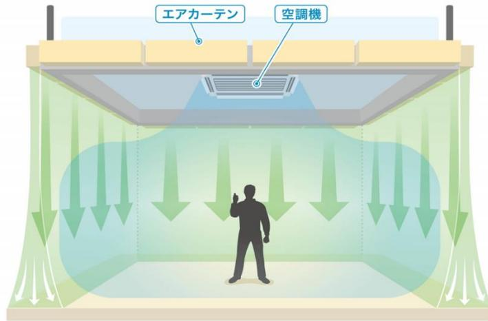
床面から3m程度の高さにエアカーテンを配置し、気流を吹出すことによりゾーン内部の冷暖気を閉じ込め快適な空間を提供。
