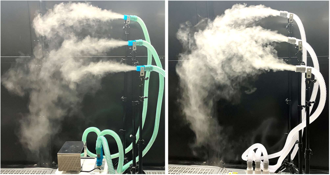
写真3 従来品(左)と新製品(右)の噴霧量の比較
