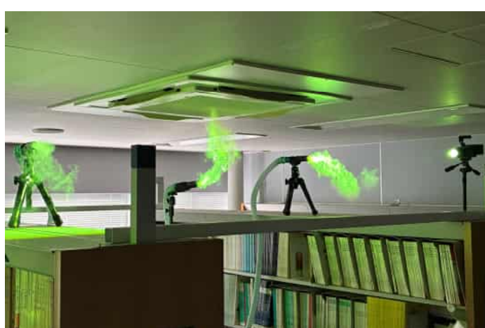
画像2 気流可視化用ミスト発生器「plus FOG」による空調気流の可視化 汎用デジカメによる撮影
