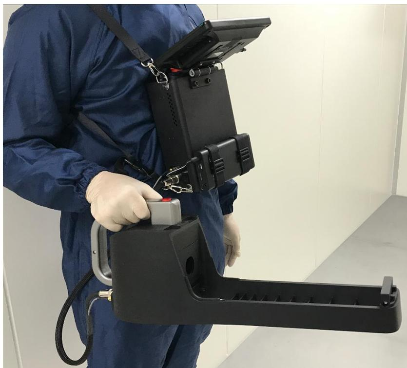
写真5 「微粒子可視化システム Type-S」のハンドリング（ハグタイプ）
