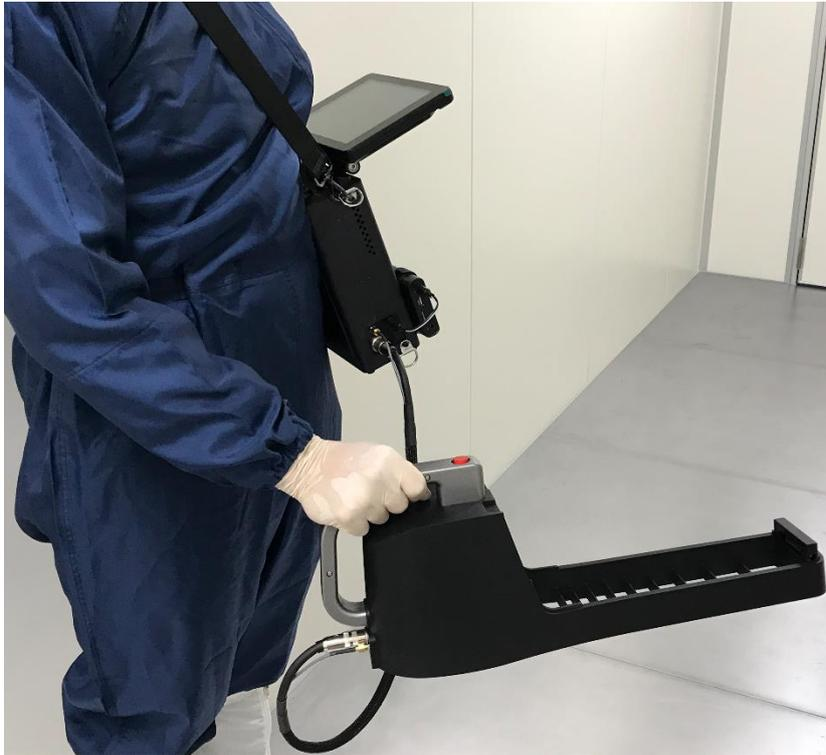
写真4 「微粒子可視化システム Type-S」のハンドリング（ショルダータイプ）
