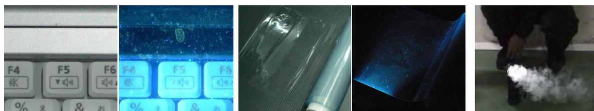
自社ブランド「ViEST®」として展開している当社の微粒子可視化技術は、80ナノメートルの浮遊粒子をリアルタイムに映像化できる世界最高水準の撮影感度をもった可視化技術です。
