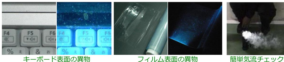
自社ブランド「ViEST®」として展開している当社の微粒子可視化技術は、80ナノメートルの浮遊粒子をリアルタイムに映像化できる世界最高水準の撮影感度をもった可視化技術です。
