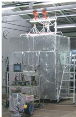
独自の性能試験で遮熱塗料の熱特性値を分析
