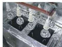
独自の性能試験で遮熱塗料の熱特性値を分析
